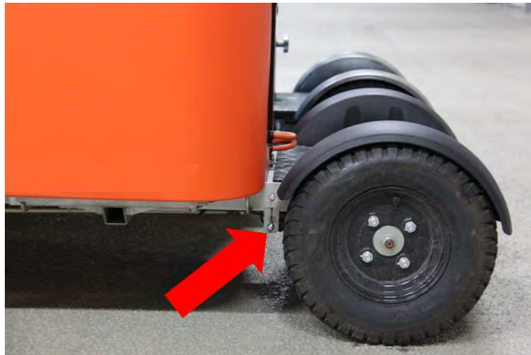
Figuur 8: Nieuwer model Stint: Vrijloophendel voor linker achterwiel
