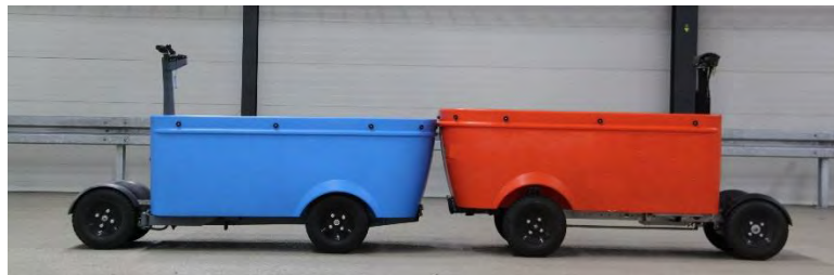
Figuur 9: Vergelijk hoogte opbouw keuringsvoertuig (links) en nieuw model (rechts)
