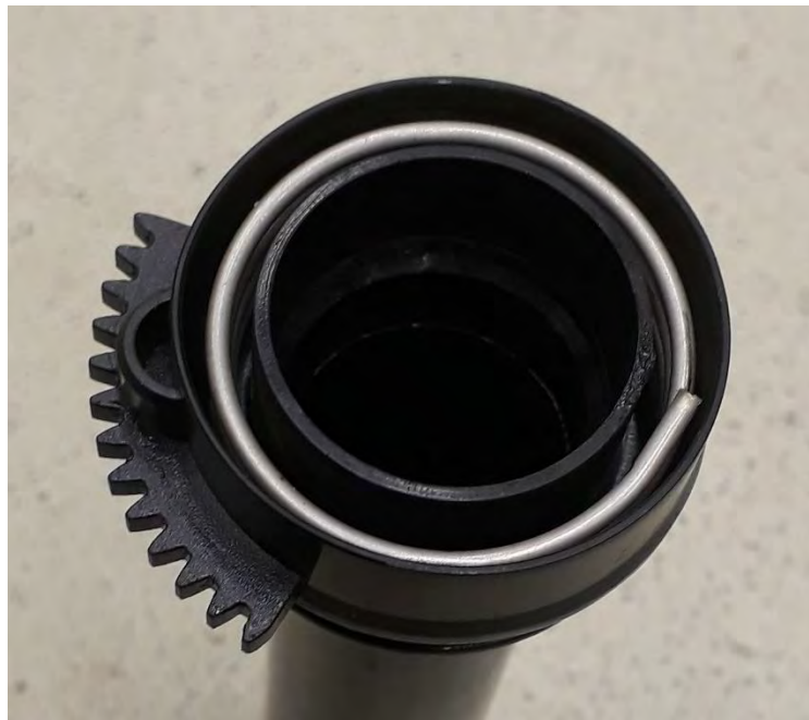
Figuur 17: Handvat met (gebroken) veer
