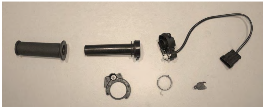
Figuur 16: Gedemonteerde gashendel
